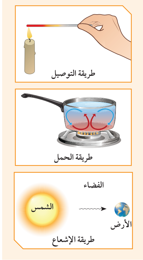
شكل (86): طرق انتقال الحرارة
