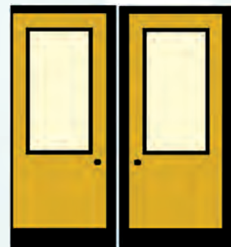
أبواب مروحة بنوافذ تدفع للفتح وتستخدم لغرف العمليات والمطابخ
