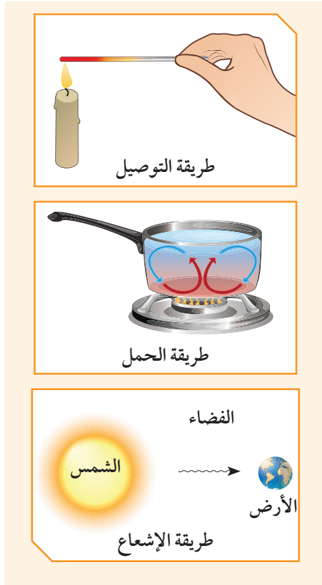
شكل (86): طرق انتقال الحرارة
